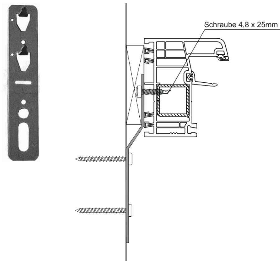
Eine druckfeste Hinterfüterung der Befestigungs- und der Verriegelungspunkte ist, sofern der Abstand von Befestigungs- und Verriegelungspunkt maximal 100 mm nicht übersteigt, nicht erforderlich. Ist der Abstand größer als 100 mm, muss im Bereich des Verriegelungspunktes zwischen Blendrahmen und Mauerwerk zusätzlich druckfest hinterfütert werden; zum Beispiel mit einem Klotz aus Hartkunststoff oder vergleichbarem.
